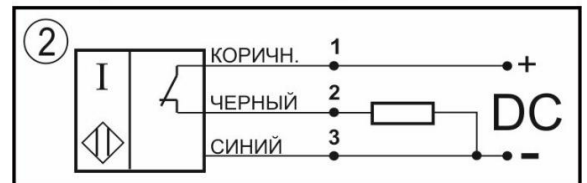
Цоколевка клеммной колодки
