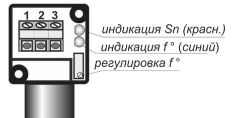
Цоколевка клеммной колодки
